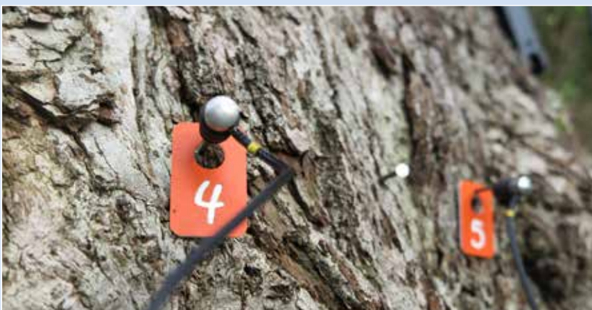
Het aanbrengen van meetsondes op de eik
